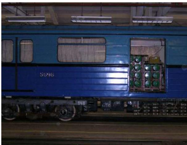
Рисунок 20 – Вагон-лаборатория в депо «Выхино» с экспериментальной силовой установкой для автономного хода ЭПС [91]
