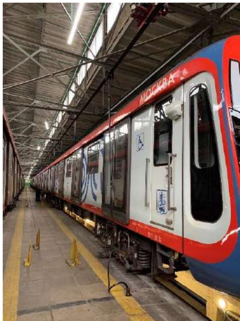
Рисунок 11 – Навесные шины с гибкими подводами напряжения в депо
