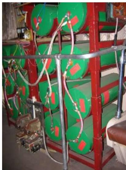
Рисунок 21 – Силовая установка на базе суперконденсаторов [91]
