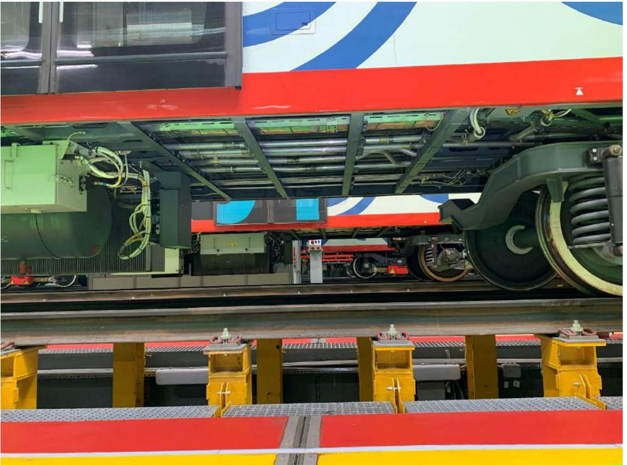
Рисунок 91 – Обследование подвагонного пространства немоторного вагона, определение свободного места для размещения накопителей энергии. Свободное место вблизи рамы тележки справа
