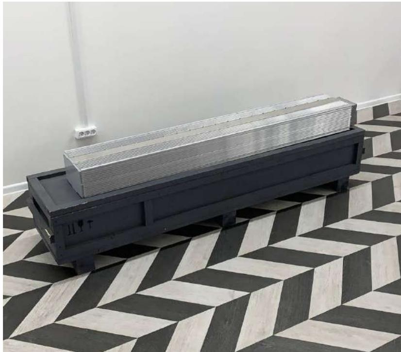
Рисунок 87 – Внешний вид суперконденсатора типа MO-150B50Φ-0-3
